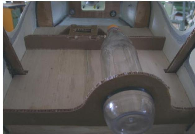
Die Halterungen für den 1 Liter Tank sind wieder aus Wabenmaterial hergestellt, es kann aber auch 4mm Pappelsper Holz mit Erleichterungslöchern verwendet werden. Die hintere Tank-Halterung hat einen Sperrholzring aus 0,8mm Material, dieser ist mit CFK-Rowings umwickelt und an das Wabenmaterial angeklebt. Am vorderen Spannt wird der Flaschenhals nur eingelegt und mit 2 Kabelbindern an CFK-Stangen fest gesichert. Ebenso nimmt dieser Spannt gleich das Gasservo mit auf !
