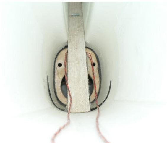
Auf diesen Fotos ist der Seitenleitwerks-Abschlußspant aus Balsa gezeigt, dieser ist mit Gewebe belegt und mit dem Rumpfboden verklebt, dahinter ist noch ein Ringspant für das Höhenleitwerk und die Verkabelung der beiden Höhenruderservos zu sehen !
