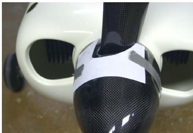
Links ist der 1 L. Tank und Zündungsakku zu sehen, rechts ist ein Stück Pappe das um die Abmessungen der Luftschraube ausgeschnitten wurde auf den Spinner geklebt. Mit einem Dremel wird dieser Stück für Stück auf das passende Maß geschliffen !
