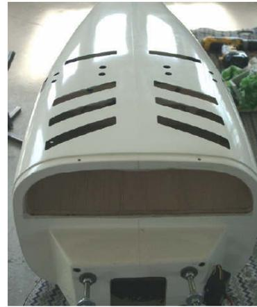
Die Kühlöffnungen sind einfach von innen mit CFK-Rowings versehen, dieses ergibt eine Bessere Haltbarkeit gegen Beschädigung, auf dem rechten Bild sind noch einmal alle Öffnungen für die Schalldämpferkühlung gezeigt.
