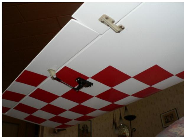
Als nächstes werden die doppelten GFK-Ruderhörner, linkes Bild, angeschliffen und mit den M3 Gabelköpfen verschraubt, an den Flächen angezeichnet und herausgearbeitet.
