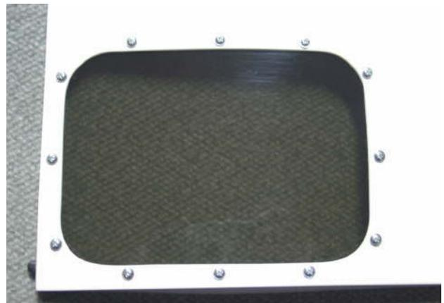
Der Rumpfdeckel kann nun fertig ausgeschnitten und angepasst werden. Die Fenster mit einem Dremel heraustrennen, verschleifen und die Schraubenlöcher von 2,5mm in das GFRK bohren. Ich verwende die MPX-Schrauben 2,2x6mm diese werden in der Scheibe auf 1,5mm aufgebohrt und mit gutem Silikon noch zusätzlich verklebt. ( Lochabstand ca. 4cm )
