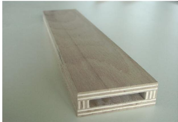
Jetzt wird die Fahrwerkstasche aus wirklich stabilem Flugzeugsperrholz in 3 Ebenen mit Eyoxid-Harz verklebt aufgebaut. Das Fahrwerk als Muster verwenden, dieses sollte ja später auch wieder in diese Tasche passen. Die Länge der Tasche ist etwas breiter als der Rumpf, die tiefe der Tasche Fahrwerk + 1cm auf jeder Seite!
