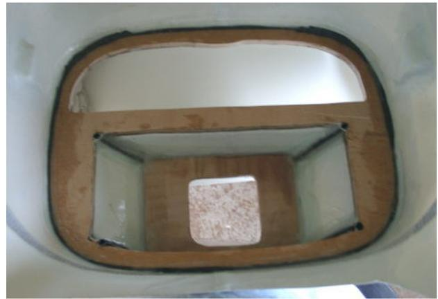
Jetzt wird das gleiche mit dem großen weiter zurück gesetzten Spannt gemacht, siehe rechtes Foto, 6-8mm Sperrholz je nach eingesetztem Motor.
