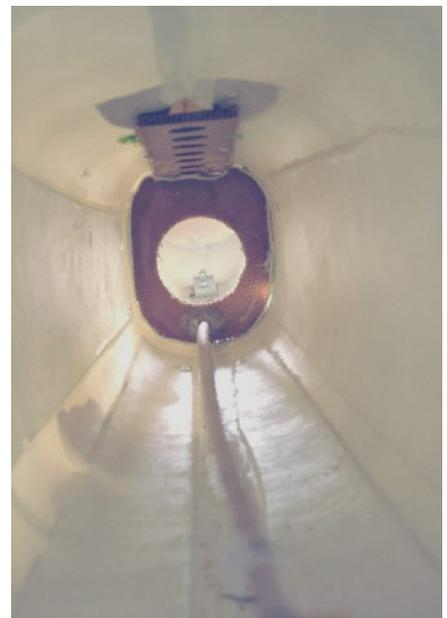
Als nächste Arbeit kommt die Verstärkung des Seitenleitwerks auf den Plan, dieser Bereich wird mit einem Schleifholz, links gezeigt angeschliffen, dann mit einem Wabenmaterial oder leichtem Sperrholz von innen verstärkt. Ich habe zum pressen der Teile einfach ein Stück Lappen mit in den Rumpf geschoben, dieser drückt die Verstärkung schön nach oben.
