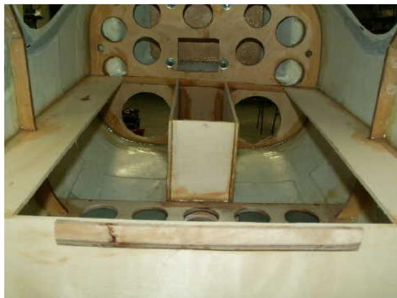
Wenn die Motorbefestigung abgeschlossen ist kommen wir zum Dämpfereinbau in den Rumpf. Da bei starkem Schleppbetrieb der Rumpf sich zu stark aufheizen würde bekommt die Dämpferanlage ein eigenes Fach.
