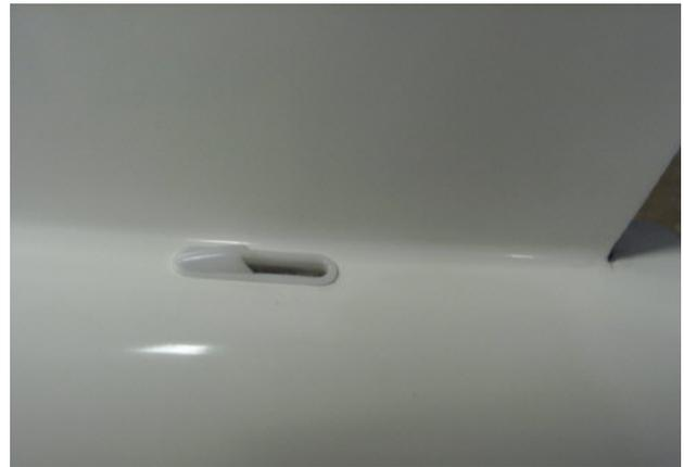
Die beidseitige Rumpfföffnung für die doppelte Seitenruderanlenkung mit Seilen habe ich wie auf dem oberen Foto zu sehen ist mit einem Dremel bearbeitet und mit Kunststoffeinsätzen versehen. Das gleiche habe ich mit den Anlenkungen für das Heckfahrwerk gemacht.
