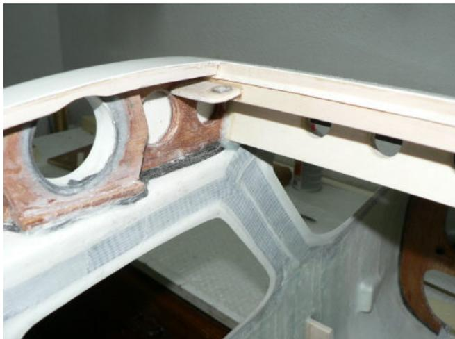
Diese Fotos zeigen die Halterung für das Schleppkupplungsservo und die Hülle für die 45mm Flächensteckung, alle Verstärkungen mit Erleichterungslöchern versehen !
