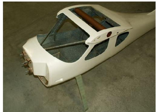
Wenn alle Verstärkungen eingebaut sind können die Fenster angezeichnet und dann ausgeschnitten werden. Bei der Frontscheibe bleibt ein umlaufender Rand von 6mm stehen, die Scheibe wird dann später von außen verklebt oder geschraubt.
