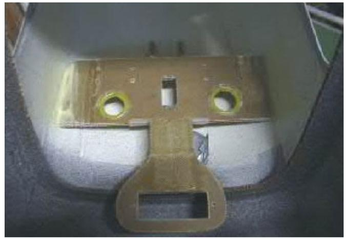
Hier ist der Aufbau für das mittige Seitenruderservo, das seitliche Schleppkupplungsservo noch in Klebeband eingepackt und den Empfängern zu sehen. Die beiden Empfänger kommen beidseitig vor den Kabeldurchführungslöchern die mit Spritschlauch verkleidet sind zum Einsatz. Der große Ausschnitt im Vordergrund wird mit einem BIC-System von Emcotec gefüllt werden !
