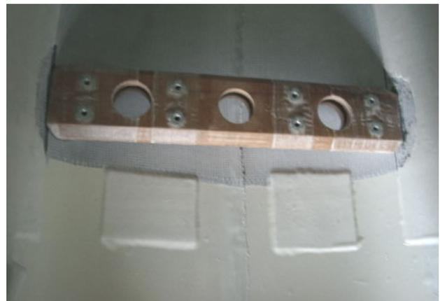
Wenn alles grob zugeschnitten ist kann die Fahrwerkstasche in den Rumpf eingepasst werden. Ist dieses geschafft werden die Fahrwerkshälften eingeschoben, die Position durch die Erleichterungslöcher angezeichnet und außerhalb vom Rumpf mit jeweils 4 Schrauben befestigt. Das rechte Foto zeigt die jeweils 4 Einschlagmuttern M4 die von oben sichtbar sind, das Fahrwerk wird dann später von unten verschraubt, so kann später einfach einmal das Fahrwerk gewechselt werden.
