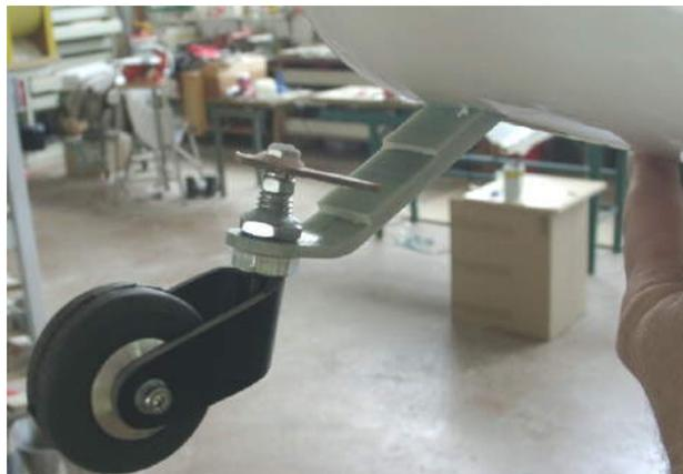
Jetzt kann ein Stück von 80/30mm Sperrholz, mit 2 Lagen 160g/m<sup>2</sup> Glasgewebe in den Rumpf geharzt werden. Bitte immer Langzeitharz verwenden, alles gut vorher anschleifen. Nun können die beiden Bohrungen von 4mm durch den Rumpf und das Heckfahrwerk gemacht werden. Diese Löcher von unten schön ausreiben, Senkschrauben einschieben, Fahrwerk aufstecken und alles mit 2 Stopfmuttern sichern. Eine schöne und von außen auch saubere Sache und später bei der Modellpflege leicht zu reinigen.
