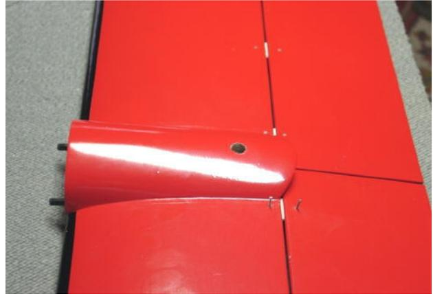
Das Anpassen der GFK-Verkleidung und das Aufkleben derselben auf das Höhenleitwerk beenden die Arbeit am Höhenleitwerk.
