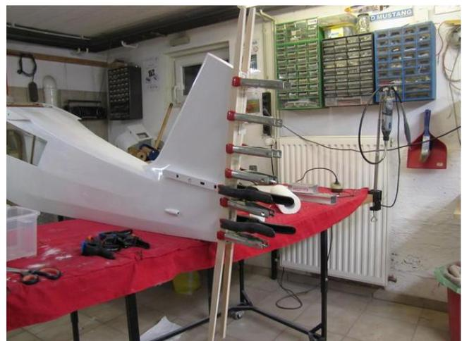
Die Sperrholzverstärkung für das Heckfahrwerk und die Abschlussleiste für das Seitenruder werden angepasst und mit Langzeitharz an Ihren Platz geklebt.
