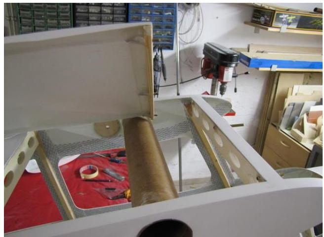
Verstärkungen für den Rumpfdeckel und die späteren Verschraubungen mit dem Rumpf.
