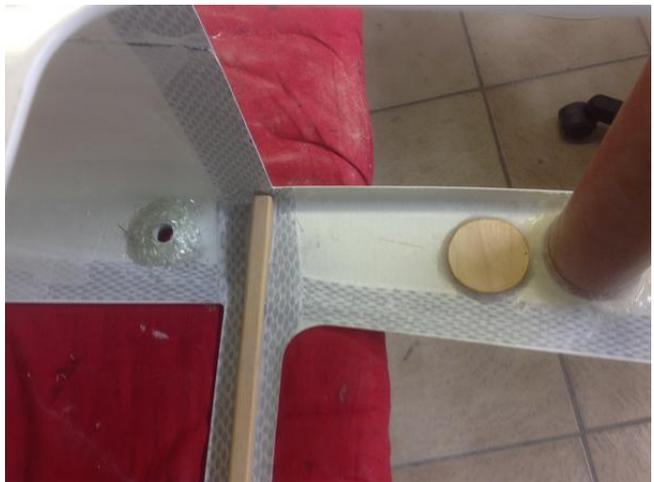
Die Flächen werden auf die 50mm Alusteckung geschoben, die Verdrehsicherungen zu Probezwecken eingesteckt, noch ohne Klebstoff und die EWD auf beiden Seiten messen und gegebenenfalls nacharbeiten zu können.
