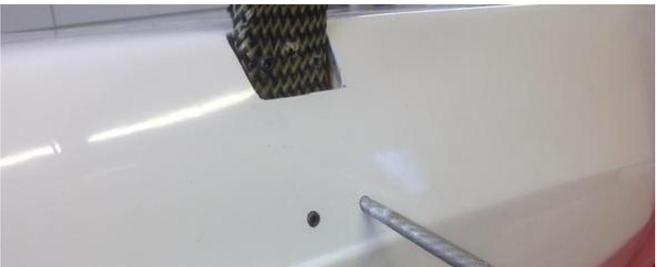
Die jeweils 4 Befestigungsschrauben der einzelnen Fahrwerksbügel werden ausgearbeitet.
