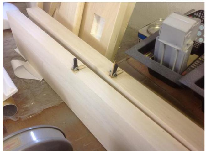
Die Querruder sind schon fertig verkastet, verschliffen und mit Scharnertaschen versehen. Die Landeklappen sind unter der Balsa-Bepunktung auch mit Verstärkungen für die Landeklappen vorbereitet, diese sollten aber auch aus dem weichen Balsa mit Sperrholz verstärkt werden, die oberen Bilder zeigen das viel besser was ich hier schreiben möchte !
