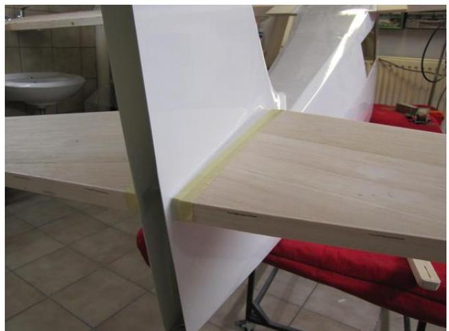
Bei eingeschobener 50mm Flächensteckung oder kompletten Flächen werden die Steckungshülsen für das Höhenleitwerk in den Rumpf geklebt, dabei auf geraden Einbau achten. Die Hauptsteckung/Flächen kann dabei wunderbar von hinten angepeilt werden, das ganze dann mit Tesa-Krepp über die Trockenphase fixieren !
