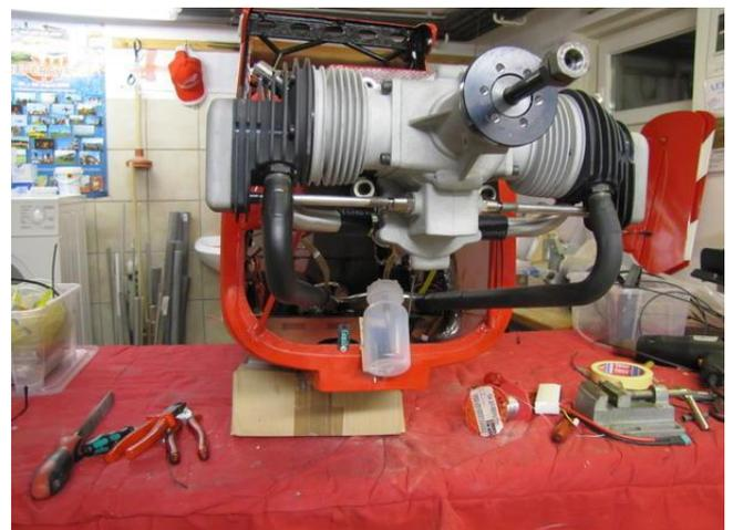
Der Einbau eines Valach 170ccm zeigen die oberen Bilder, die Ausschnitte der Motorhaube für die Zylinder mit einer Kunststoffplatten als Ausfräshilfe !
