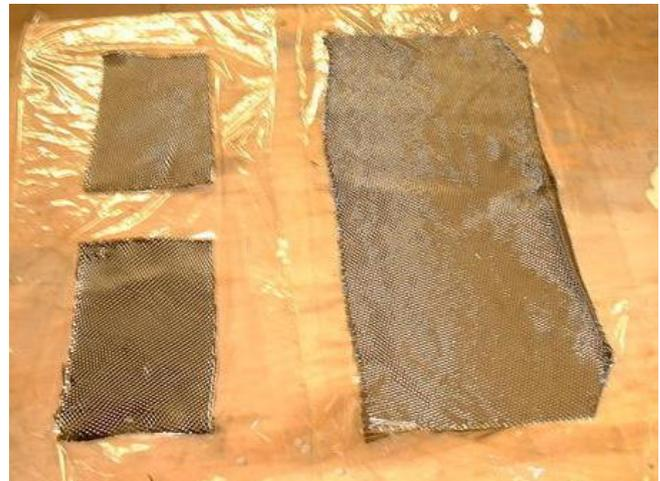
Wenn der Rumpf im Fahrwerksbereich großräumig vom Styro befreit und angeschliffen wurde können die CFK-Verstärkungen für das Fahrwerksbrett auf einer Folie vorgetränkt werden. ( Schaumstoffwalze )
