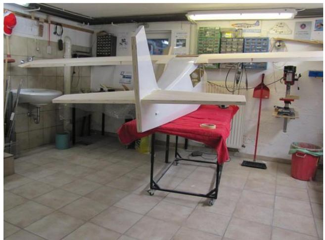
“ 5 Löcher mit 58mm + 2 Löcher mit 30mm pro Höhenruderhälfte“ + “14 Löcher je 40mm + 4 Löcher je 58mm im Seitenruder “ !
