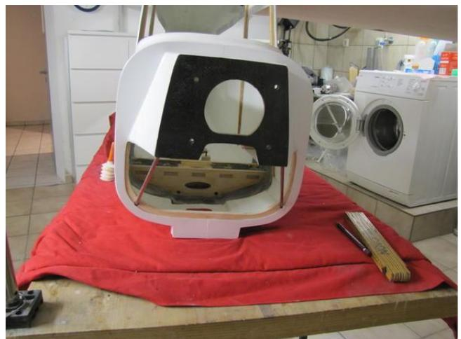
Beim Einbau eines Valach 170ccm 4-Takters mit auch der Motordoom neu gemacht werden, um das passende Maß kürzen und vorne neu verschließen.
