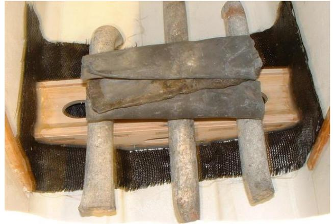
Vor dem einkleben der Teile werden die beiden Fahrwerksbügel von außen an der Rumpf gehalten, die Fahrwerksposition ist ganz leicht am Rumpf durch eine Vertiefung angezeichnet, diese wird überprüft und zu klein herausgeschnitten.
