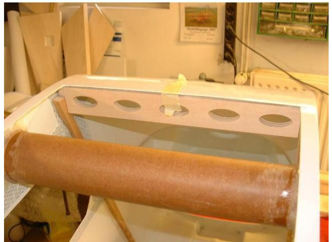
Diese werden oben in den Rumpfdeckel eingesetzt, sauber ausgerichtet und komplett verklebt. Die hintere Verstärkung nimmt dann später auch noch die Schleppkupplung auf, eine zusätzliche CFK-Matte zur besseren Kraftverteilung könnte also nicht schaden.
