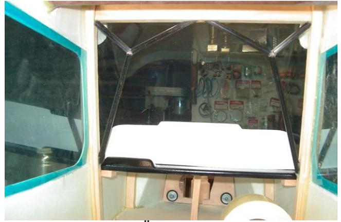
Jetzt können alle Seitenscheiben zugeschnitten, 10mm allseitigen Überstand, und mit Silikon oder Scharniersilikon von innen eingeklebt werden, die Frontscheibe wird erst nach Beendigung aller Arbeiten von außen angeschraubt bzw. verklebt !
