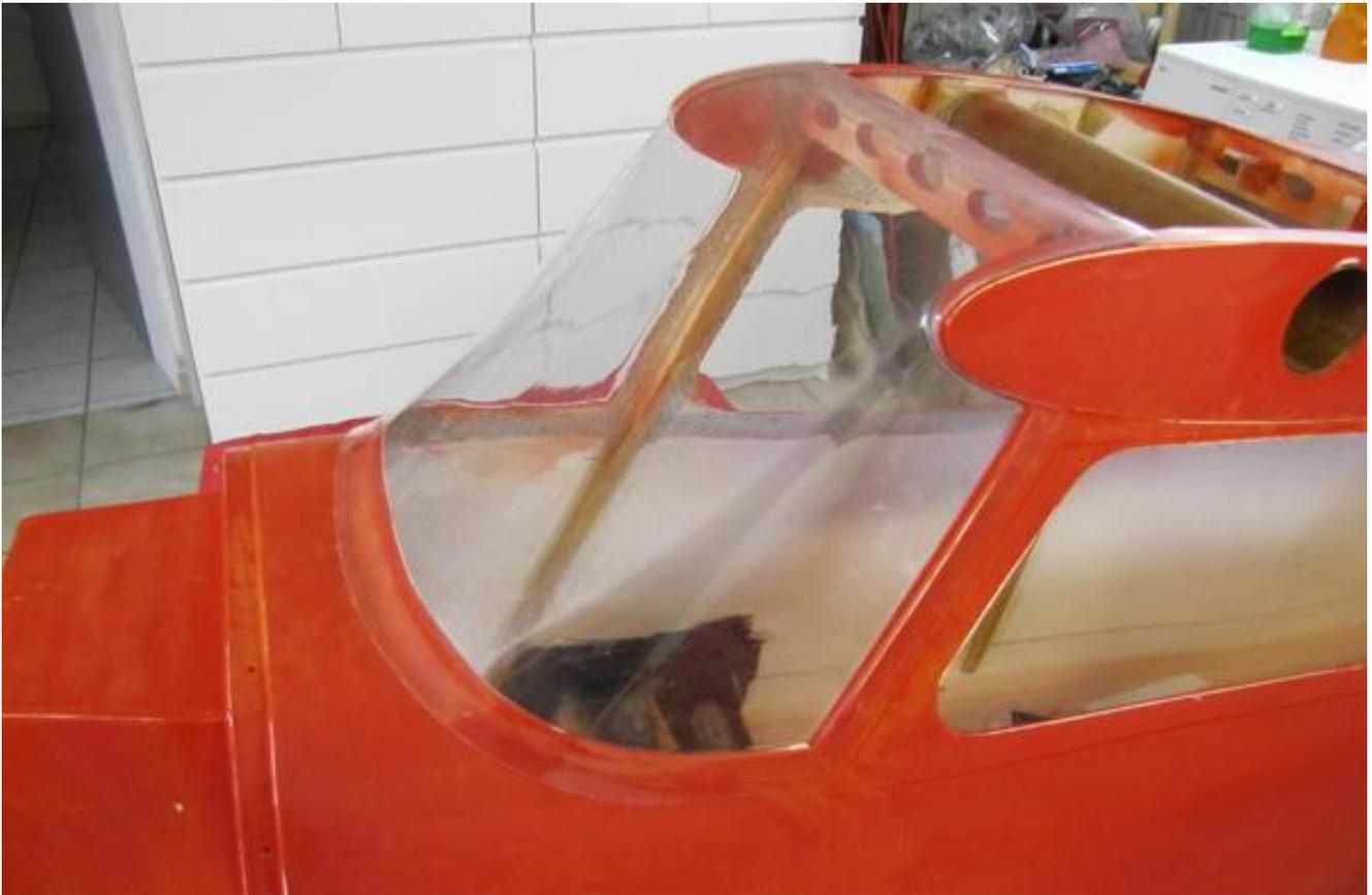
Die Frontscheibe wird wie auf den letzten beiden Bildern zu sehen ist am Rumpf passend geschnitten, oben mit der Wurzelrippe der Fläche bündig.
