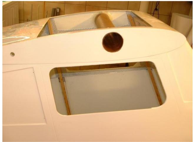
Die Frontscheibe wird so ausgeschnitten das an den Seiten noch 3mm stehen bleiben, an der Wurzelrippe 10mm und am Deckel die dicke des Holmes.
