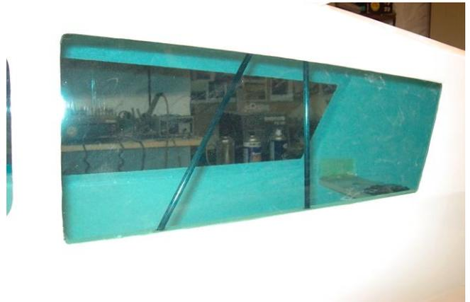
Die vorderen Seitenscheiben links gezeigt sind frei von Verstrebungen, die hinteren Seitenscheiben haben zwei CFK-Rohre die etwas kegelförmig zusammenlaufen, diese werden mit Sekundenkleber oder Epoxid-Harz auf die quer liegenden 10/10mm Balsaleisten “über und unterhalb der Fenster“ angebrachten Leisten verklebt.
