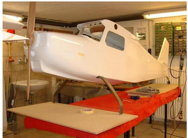
Nach dem verkleben der Teile werden die Fahrwerksbügel seitlich eingeführt und bei Bedarf die Ausschnitte nachgearbeitet.
