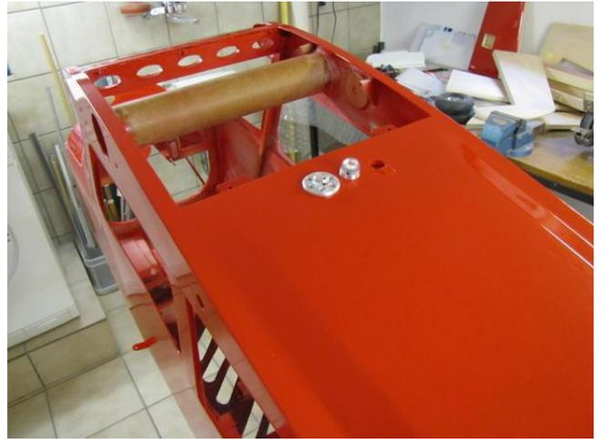
Hintere Verstärkung des Rumpfes für die Schleppkupplung, rechts das ganze fertig !
