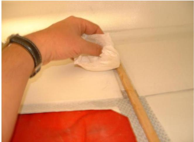
Das alle Verklebungen vorher vom Styropor befreit und sauber angeschliffen, nichts mit 5 min. Epoxid verklebt und besonders auf das Gewicht geachtet wurde ist eine Selbstverständlichkeit, sonst landet das Modell schnell bei 24,99 kg Abfluggewicht !
