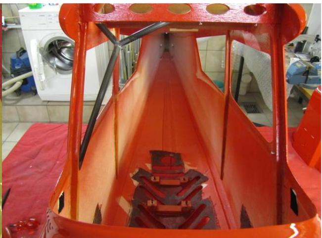
Die Verstärkungen der Rumpfecken vorne für die Scheiben werden aus 8 mm CFK-Rohr lt. Skizze gefertigt und sauber verklebt.
