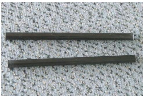
CFK- Steckung V-Leitwerk , 8mm
