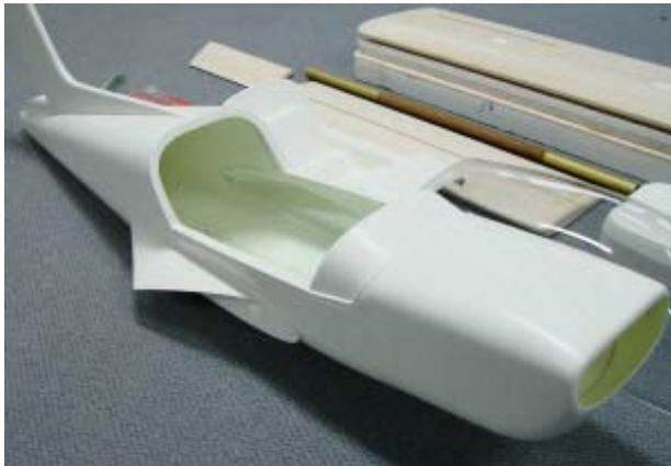
Der GFK-Rumpf inkl. angeformter Motorhaube ist an der Markierung zu trennen und je nach verwendetem Motor mit dem passenden Abstand und dem Motordom zu verkleben !
