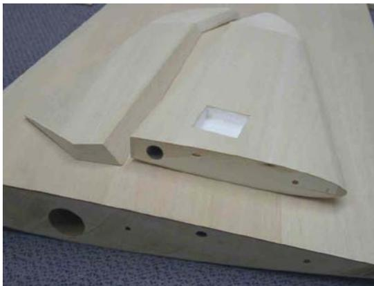
**Höhenleitwerk wie auch die Flächenhälften sind mit fertiger Steckung und Verdrehsicherung ausgestattet.**
