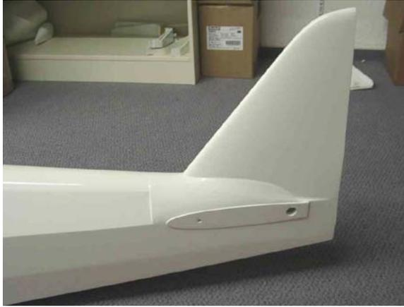
**Dieses Foto zeigt die auch schon fertige Leitwerkssteckung und Verdrehsicherung.**
