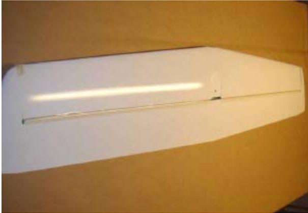
Das ebenso leichte Voll-GFK-Höhenleitwerk ist hier mit fertiger Verschraubung und vordere Lagerung zu sehen.
