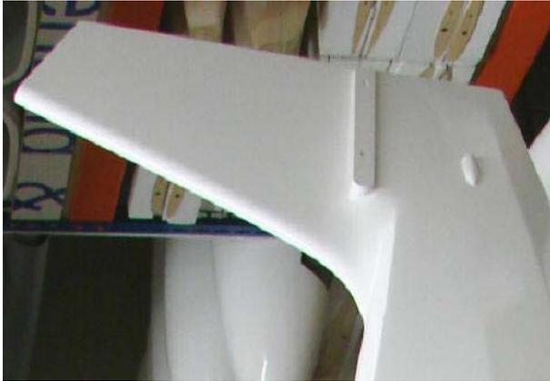
Dieses Foto zeigt die auch schon fertige Leitwerkssteckung und Verdrehsicherung inkl. der Gestängeabdeckung.
