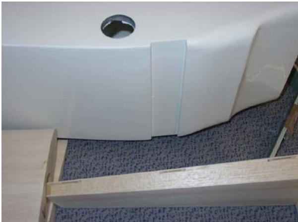
Auf diesem Foto ist am GFK-Rumpf die Fahrwerksnut und die Flächensteckung gut zu erkennen, ebenso am stehenden Höhenruderblatt die fertigen Scharniertaschen !
