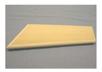
Seitenleitwerk in Styro - Furnier mit allen GFK - Verstärkungen unter der Abachi - Beplankung fertig versehen, Nasenleisten, Randbögen und bügelfertig verschliffen.
