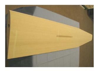
Tragflächen mit 25mm Glas- Steckung, T-Holm mit CFK - Holmbrücke, und 160g/m² GFK-Gewebe komplett diagonal unter dem Abachi verlegt.
