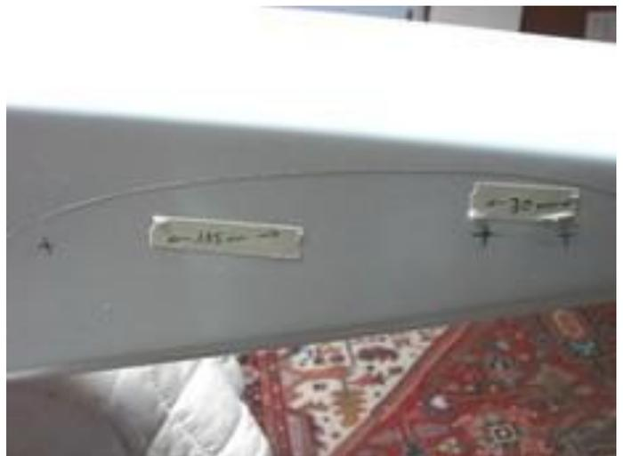
Wegen einem besseren Zugang werden am GFK-Rumpf-Seitenruderanschluss zwei größere Löcher gebohrt, durch diese hat man eine bessere Übersicht für die späteren Verklebungen. Die Verschraubungslöcher am GFK-Rumpf werden mit Schleifpapier glatt geschliffen, die Verschraubungen eingesetzt und mit Muttern an ihrer Position fixiert. Nun können die Aluhülsen mit den Holz-Gegenlagern über die Schrauben gestülpt und satt eingeklebt werden – Vorsicht bei den Schraubenköpfen—diese nicht mit festharzen !!!!
