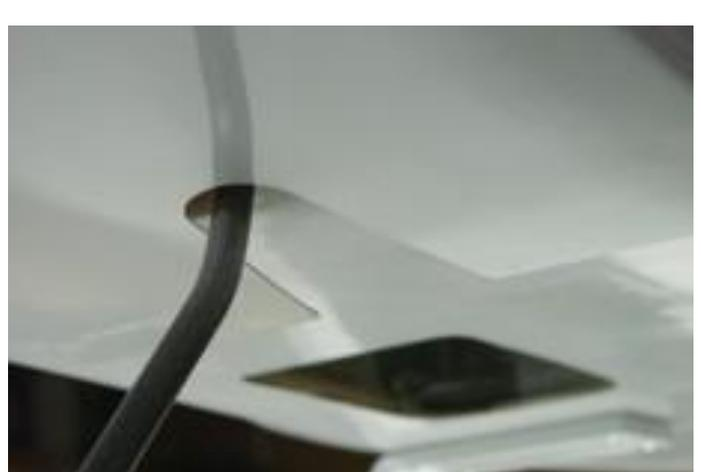
**Weiter geht es mit dem Bugfahrwerk, dieses wird so eingebaut und in der Länge gekürzt das die Tragfläche an der Nasenleiste zur Endleiste gemessen 1 – 2cm Anstellung hat !**
