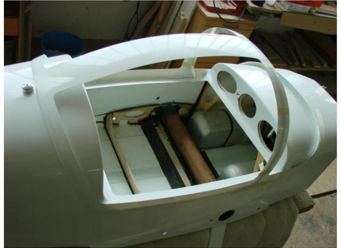
**Die beiden Teile nach dem Ausschneiden der Verglasung zusammenkleben und später mit 4 bis 5 Schrauben auf den Rumpf setzen.**
