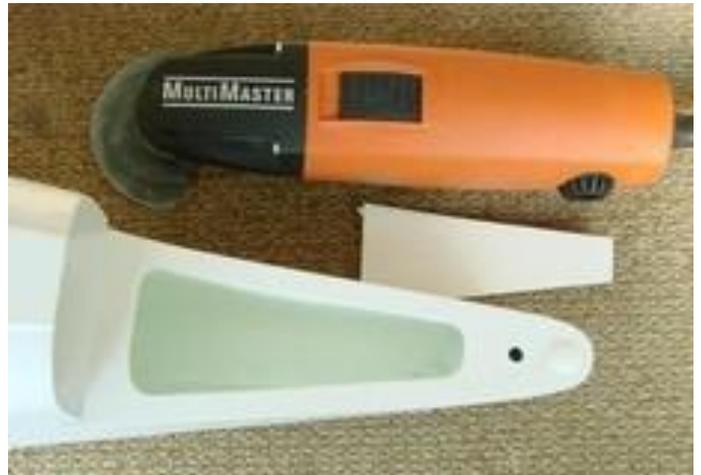
**Die Verschraubung M6 Stahlschraube ist Werksseitig schon eingelassen muss nur von Harzresten mit einem Schleifaussatz für den Dremel vorsichtig freigeschliffen werden !**
