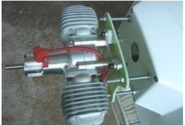
Nach der Montage der Motorhaube sollte der Spinnerübergang dann so aussehen !
