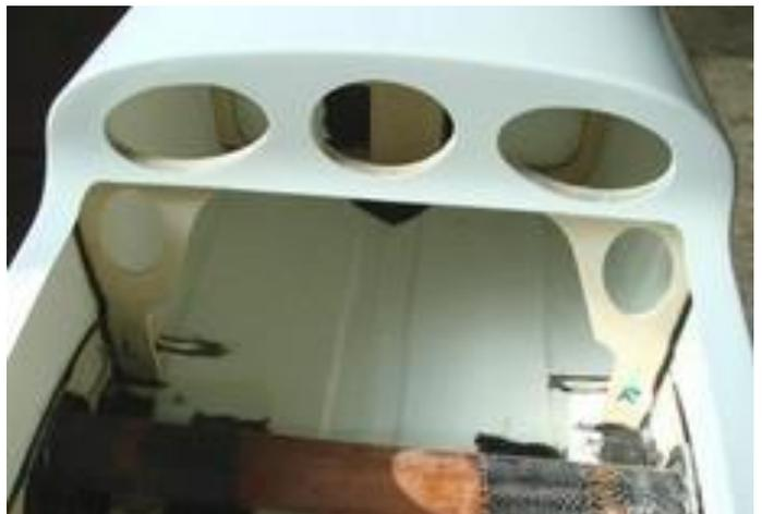
Nun werden die beiden Löcher vorne am Hauptspant für die Dämpfertunnel geschnitten oder gefräst, bitte bei dieser Arbeit den Ringspant nicht unnötig schwächen, der Dämpfertunnel kann an diesem vorderen Bereich auch leicht etwas der Öffnung durch zusammendrücken angepasst werden.
