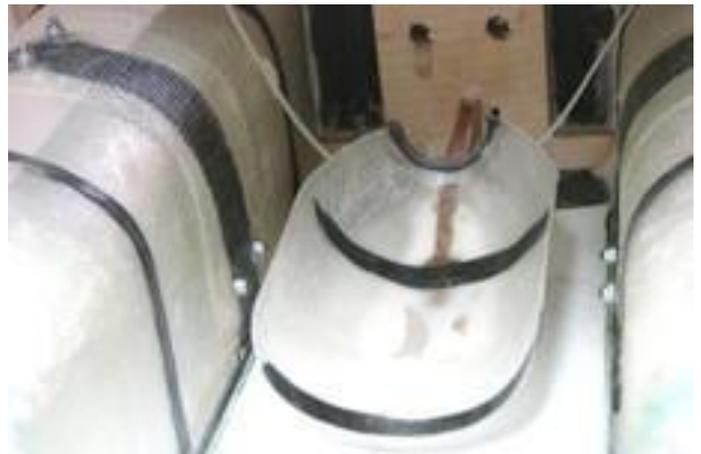
**Zwangskühlungen für den Motor aus 4mm Balsa, mit Sekundenkleber und Pulver verklebt, geschliffen und eingeklebt.**
