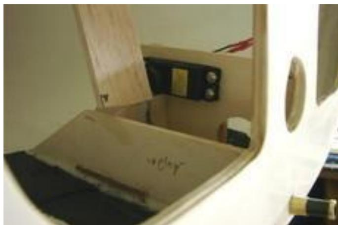
**Mit CFK-Gewebe vorher verstärkt und mit 2 CFK-Rohren zum Rumpfboden abgestützt !**
