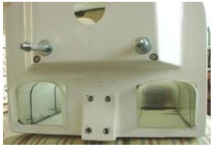
Die Dämpfertunnel werden im vorderen Bereich dem Rumpf angepasst, Ecken abgeschnitten so dass die Tummel von hinten in den Rumpf geschoben werden können.
