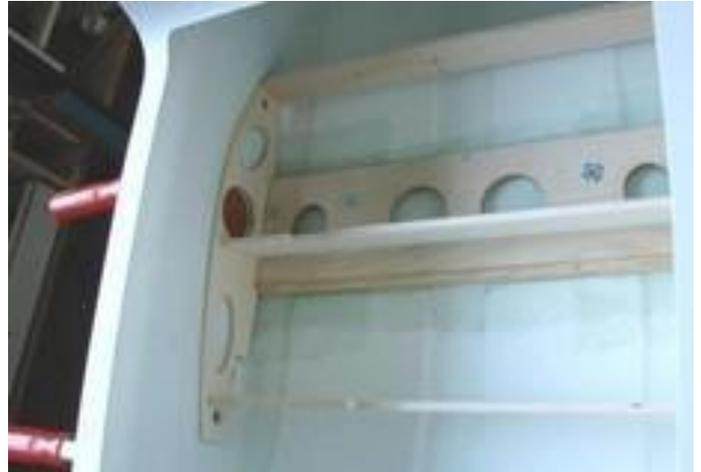
**Steg aus Multiplex-Sperrholz mittig auf das Fahrwerksbrett / Steckungsloch geklebt !**
