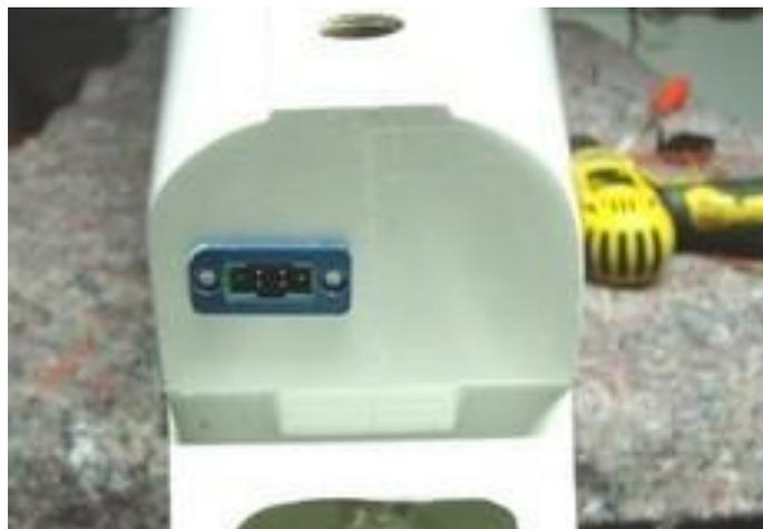
**Die Verkleidung des Höhenleitwerks ( Rumpfbürzel ) wird mit Harz aufgeklebt !**
