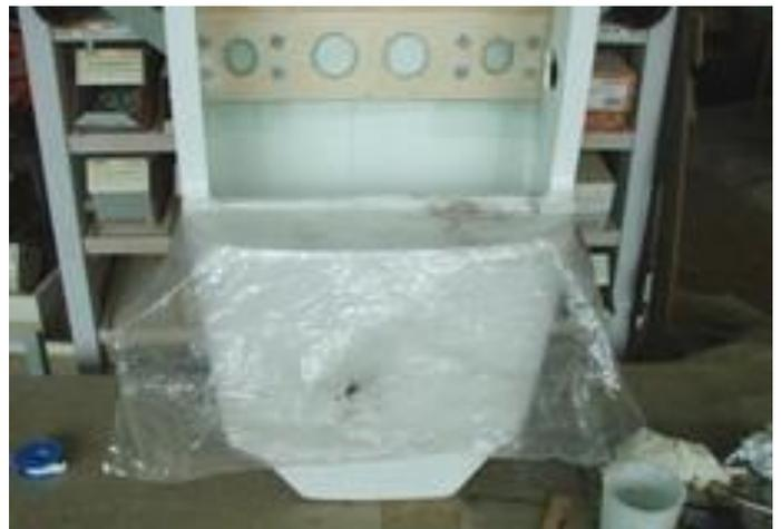
**Die Verstärkungen aus Multiplex für das Bugfahrwerk werden nun angepasst und verklebt.**
