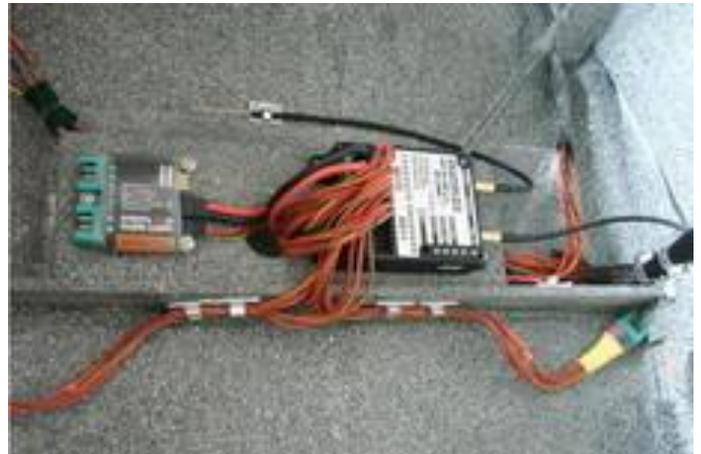
**Tankventil und Zündung an Ihrem Platz, Tank eingesetzt und angeschlossen.**
