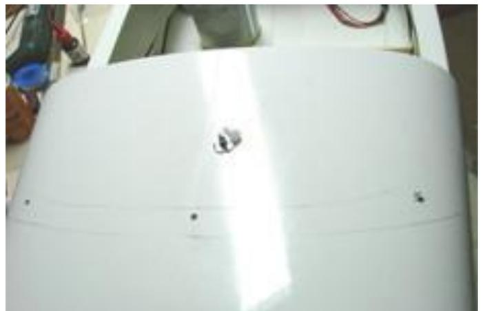
**Die beiden oberen Schrauben werden von oben auf den Rumpf geschraubt, dazu werden die Einschlagmuttern von unten in den GFK-Rumpf gesetzt !**
