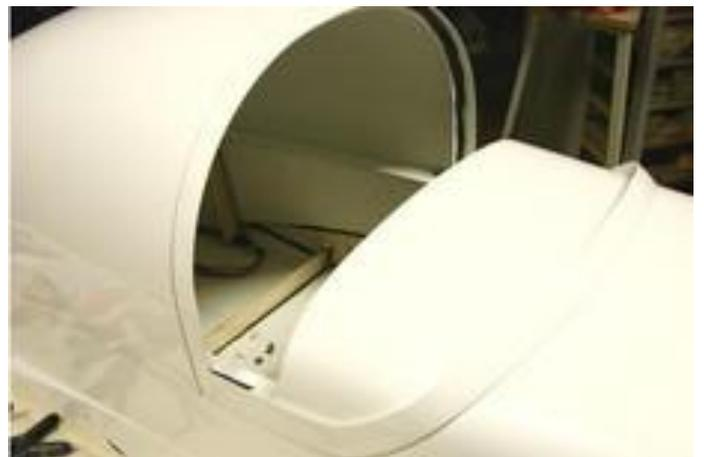
**Als Innere Haltezunge habe ich zwei GFK-Teile geschliffen und an die Innenseite der großen Schiebehaut geklebt, damit ist seitlich kein Verzug mehr möglich !**
