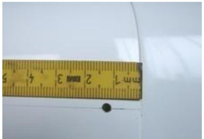
**Löcher mit 3,2mm bohren, Gewinde schneiden, mit Sekundenkleber behandeln, nach der Trockenphase nachschneiden, die Motorhaube auf 4mm aufbohren, fertig !**
