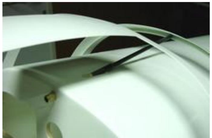
**Beide Rahmenteile sind fertig geschnitten, laufen gut und können jetzt mit dem Glasmaterial verschraubt werden. ( Klar 2mm und Ruchfarbig 1,4mm stehen zur Auswahl ! )**
