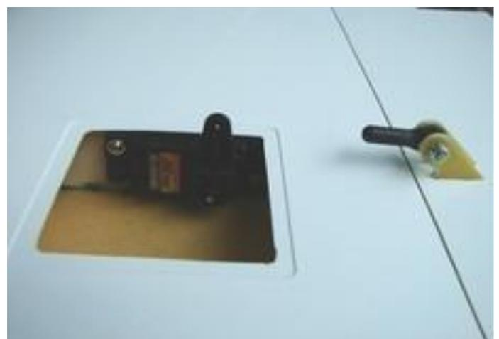
**Doppelte GFK-Ruderhörner werden eingearbeitet und mit dem Holm verklebt.**
