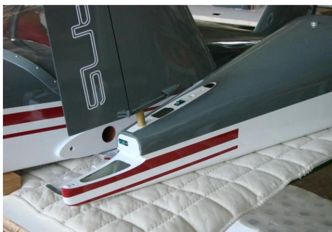
**Ruderhorn eingeklebt, Servo in die fertige Servohalterung geschraubt , Schraubensicherung bei allen eingebauten Servos nicht vergessen !**
