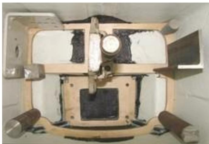
**Der fertig eingesetzte Hauptspant mit den 4 mal 8mm Kohlerohren, gefüllt mit Buchendübel
