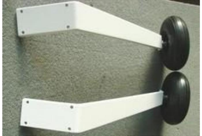
**Das fertige Fahrwerksbrett vom Spantensatz wird mit Einschlagmuttern M5 versehen, in den Rumpf bei angesteckten Tragflächen angepasst und später eingeklebt.**
