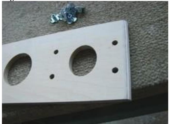
**Die Ecken am Fahrwerksbrett müssen gut abgerundet sein, bitte durch mehrmaliges Testen auf passende Größe schleifen !**
