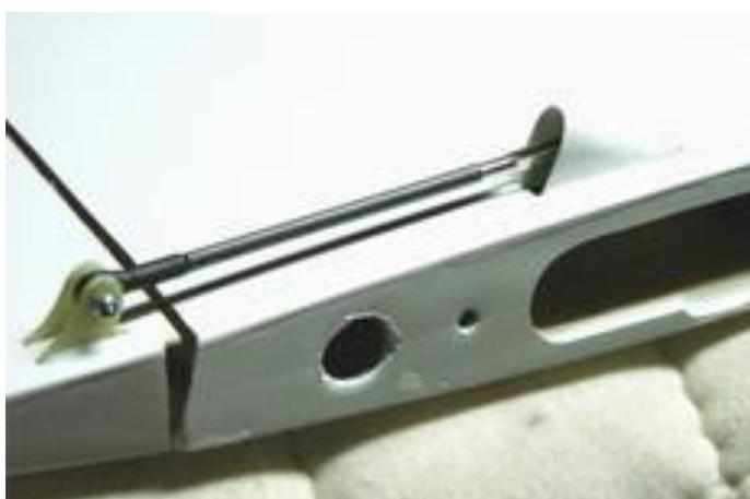
**Hinterer Rumpfspant 2-teilig eingesetzt, bringt Steifigkeit im Seitenleitwerksbereich, bei Bedarf kann in der Mitte die Lücke mit einem Balsa verschlossen werden.!**
