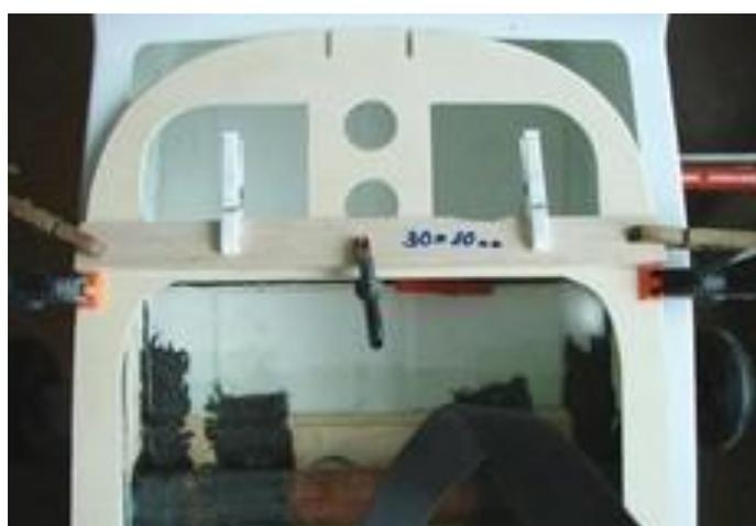
Nach der Trockenphase wird auch dieser Spant mit CFK-Rowings oder Gewebe verstärkt, dieser trägt zur Stabilisierung des doch recht großen Rumpfausschnittes entscheidend bei und nimmt auch noch später die Schleppkupplung auf.
