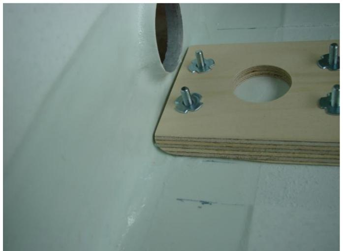
Jetzt wird der neue GFK / CFK Rumpf angeschliffen, mit einer zusätzlichen CFK-Lage verstärkt und das Fahrwerksbrett eingearzt. ( Fahrwerksbrett bei nicht aufgesteckten Tragflächenhälften aber montiertem Fahrwerk verkleben )
