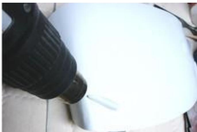
**Abdeckung aus GFK-Resten geföhnt und eingeklebt, Ruder mit M3 Gewindestange + Kohlerohr 5x3mm angelenkt !**
