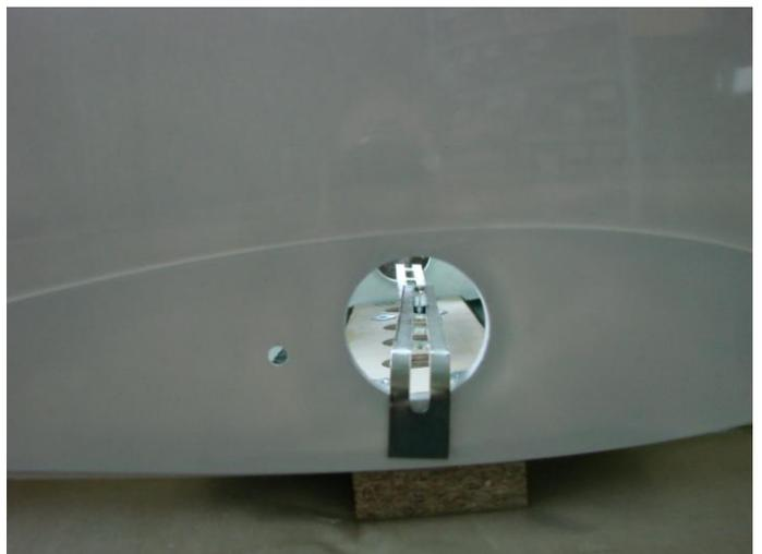
**Nach der Trockenphase kommen die beiden Verstärkungen für die Flächenwurzel an die Reihe, etwas an die Rumpfkontur angeschliffen und Probegesehen !**
