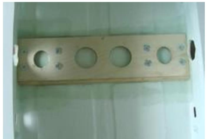
Verstärkungen aus CFK und eine Hilfe für die Rumpfbreitenfixierung ist auf den folgenden Fotos zu sehen, mit einem geraden Brett oder einer Wasserwaage auf glatte Flächenanformung achten !
