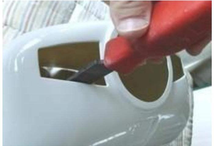
**Die Lüftungsgitter mit eingedicktem Langzeitharz eingeklebt, die Kanten der Gitter leicht nach unten gebogen, so passen sich diese wunderbar der Kontur an.**
