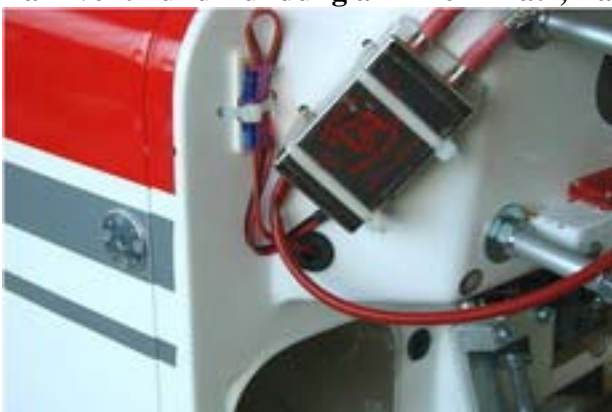
Tankventil und Zündung an Ihrem Platz, Tank eingesetzt und angeschlossen.
