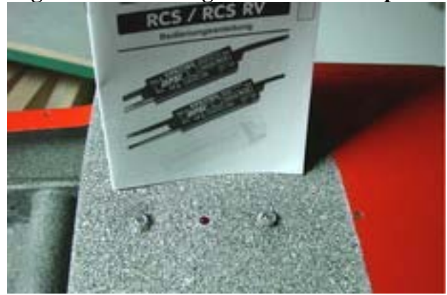
Fertige Seitenleitwerk und Rumpfbürzel in rot, eingebauter Zündungsschalter im Rumpf
