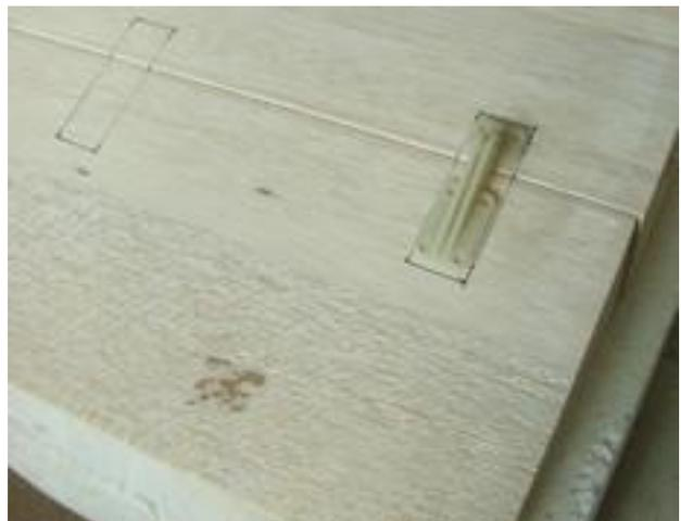
**Einen langen Streifen 1,5mm Sperrholz in die passende Größe zerlegen, die einzelnen Stücke als Schraubenverstärkung einkleben. Ohne diese Verstärkung würde es auch gehen, die weiche Balsabeplankung würde aber unter dem Schraubendruck stark nachgeben.**
