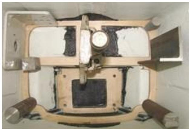
**Der fertig eingesetzte Hauptspant mit den 4 mal 8mm Kohlerohren, gefüllt mit Buchendübel
