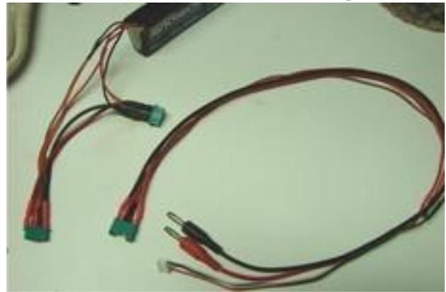
Das passende Ladekabel, Balancer mit auf den 6 Pins des MPX-Steckers gelötet, das rechte Bild zeigt eine der beiden Halterungen für die Empfängerakkus !
