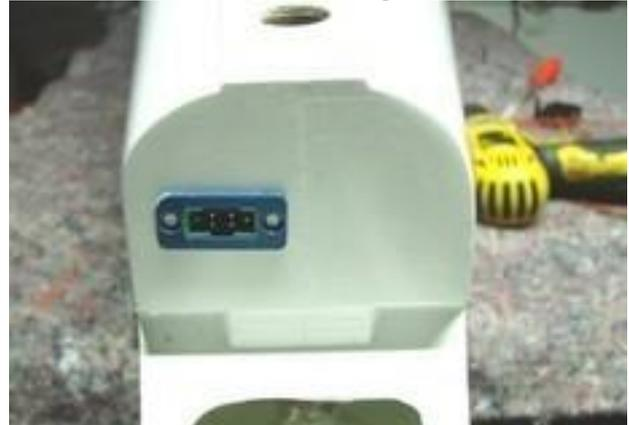
**Die Verkleidung des Höhenleitwerks ( Rumpfbürzel ) wird mit Harz aufgeklebt !**
