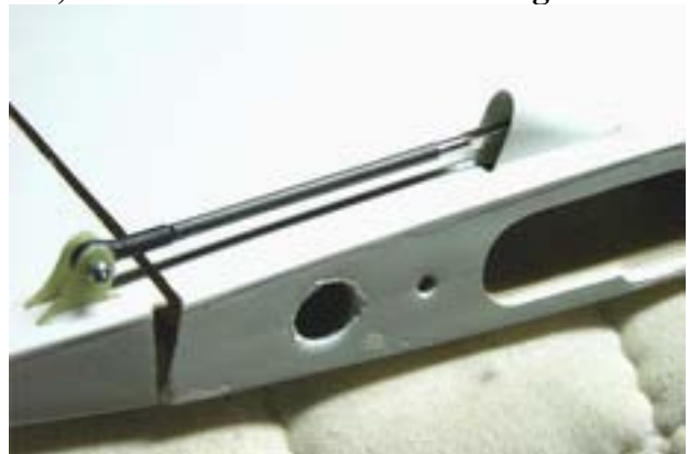
Hinterer Rumpfspant 2-teilig eingesetzt, bringt Steifigkeit im Seitenleitwerksbereich!
