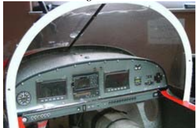
Mit Fenstergummi verklebt und eingeschraubt, schnell und einfach gemacht !
