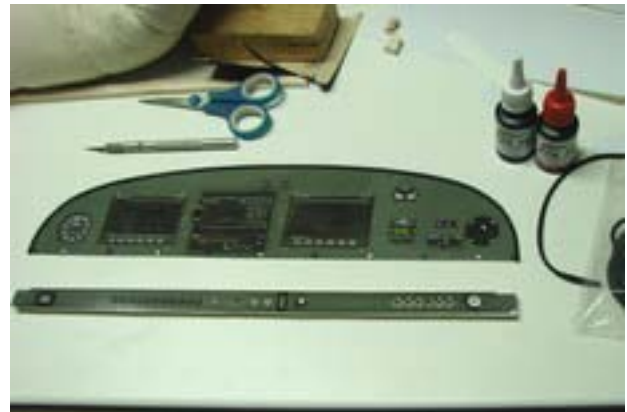
Auf eine 0,5mm ABS-Platte geklebt, das untere schmale Teil noch auf eine 5mm Balsaleiste
