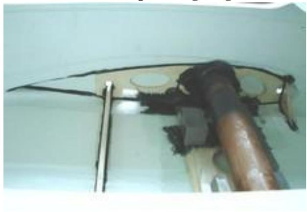
**Mittelspannten sind alle verbaut, jetzt geht es mit dem vorderen Motorspant weiter.**
