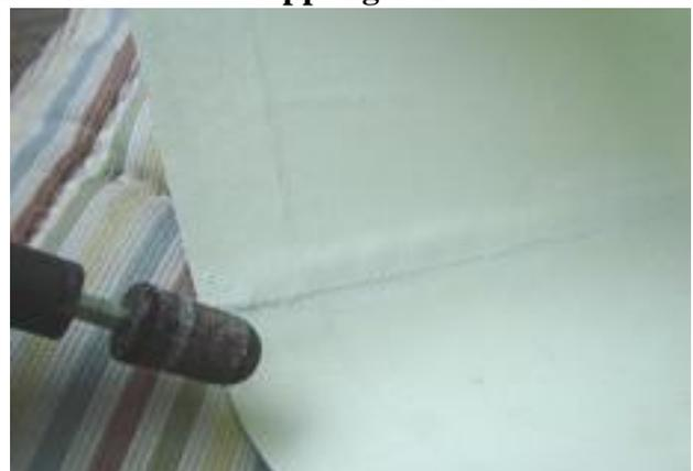
**Die Öffnungen mit einem Dremel + Feile + Schleifpapier auf die passende Größe bearbeitet.**
