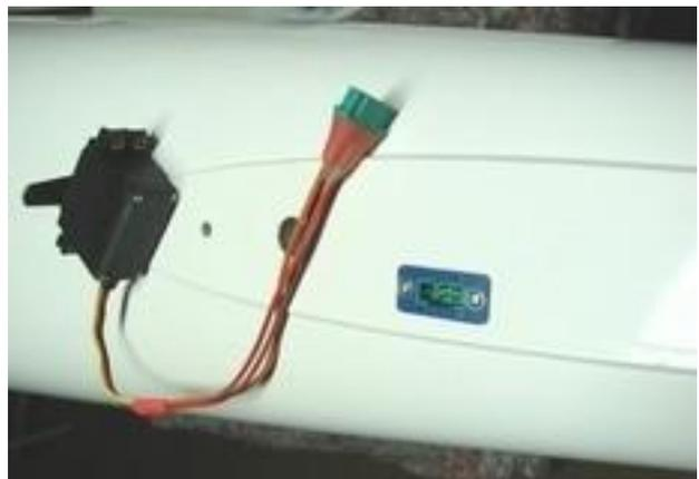
Die drei Kabelstränge für die Leitwerksservos habe ich in einem Schlauch und Punktweise mit eingedicktem Harz mit dem Rumpf verklebt. Rechts sind: Aluröhrchen, Unterlegscheiben und Holzstücke für die Seitenruderverschraubung zu sehen !
