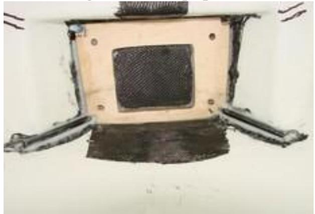
**Der große Hauptspant wird im Rumpf angepasst und mit Gewichten beschwert eingesetzt !**
