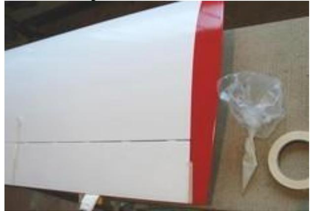
Fläche mit Kreppband abkleben und Ruderhörner einsetzen, Servos der Querruder 7985 MG
