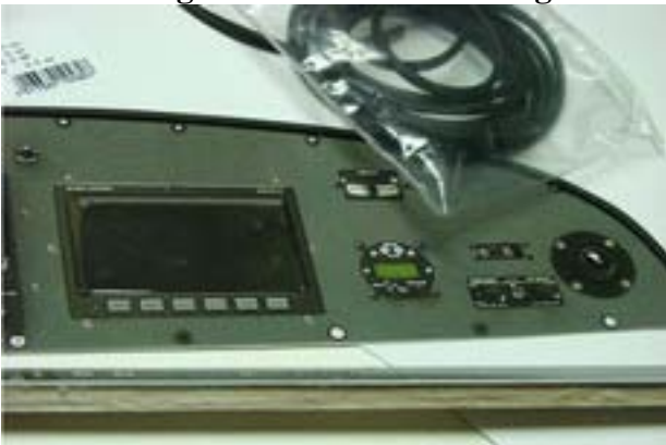
Mit Fenstergummi verklebt und eingeschraubt, schnell und einfach gemacht !
