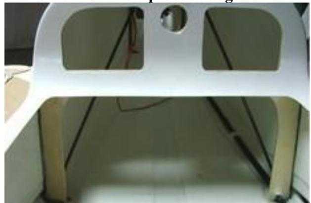
**Einbau des Empfänger + Weichenbrettes zwischen hinterem Hauptspant und kleiner Leiste zur Verdrehsicherung der Tragflächenhälften. ( Kohlerohre 5mm Durchmesser )**
