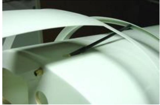
**Beide Rahmenteile sind fertig geschnitten, laufen gut und können jetzt mit dem Glasmaterial verschraubt werden. ( Klar 2mm und Rauchfarbig 1,4mm stehen zur Auswahl ! )**
