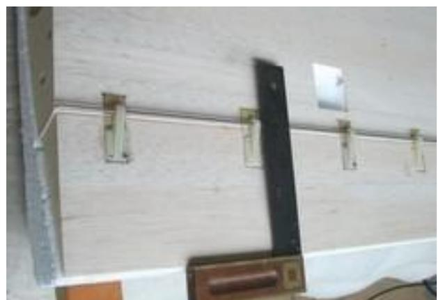
**Landeklappen getrennt, die große Fläche auf einen 3mm Stahl gefädelt und ausgerichtet, die Löcher gebohrt, Gegenstücke eingesetzt und auch gebohrt, fertig.**
