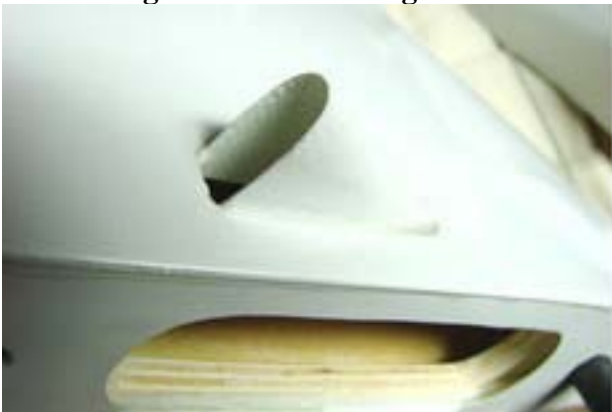
Hinterer Rumpfspant 2-teilig eingesetzt, bringt Steifigkeit im Seitenleitwerksbereich!
