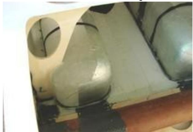
**Jetzt 2 Ausschnitte für die Abluft, diese wurden sehr groß gewählt um einen Hitzestau in den Dämpfertunneln zu vermeiden. Auch wurden die Tunnel vor dem späteren Verkleben im Rumpf von innen mit einer selbstklebenden Alufolie versehen, hat sich bei meinen anderen Schleppmodellen schon mehrere Jahre sehr gut bewährt !**
