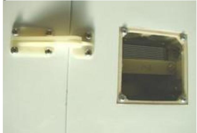
**Material für Flächenschutztaschen etwas größer zuschneiden, mit Metalleiste halten, mit Heißluftfön ein kurzes Stück behandeln, mit Holzleiste nachdrücken, fertig !**
