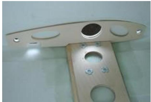
**Diese Verstärkungen werden mit: Angesetzten Flächen oder mit 2 Zulagen außen am Rumpf mit Schraubzwingen fixiert und mit dem Rumpf verklebt !**
