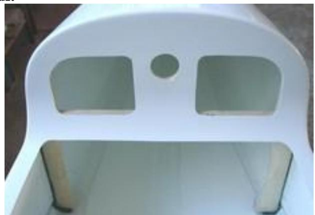
**Weiter geht es mit dem vorderen Spant des Kabinenausschnitts:**
