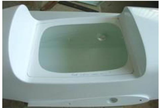
**Auf diesen Fotos nehmen wir uns den Rumpf mit seinem Flächenausschnitt das erste Mal vor, dieser wird auf ein gleichmäßiges Maß, bei mir 25mm Rand bearbeitet !**
