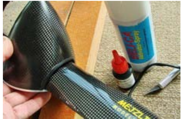
Spinnerausschnitt angezeichnet, ausgeschliffen und mit Kantenschutz versehen !
