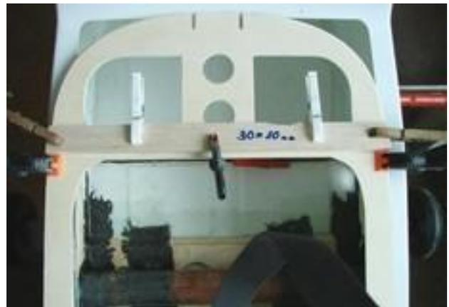
**Nach der Trockenphase wird auch dieser Spant mit CFK-Rowings oder Gewebe verstärkt, dieser trägt zur Stabilisierung des doch recht großen Rumpfausschnittes entscheidend bei und nimmt auch noch später die Schleppkupplung auf.**
