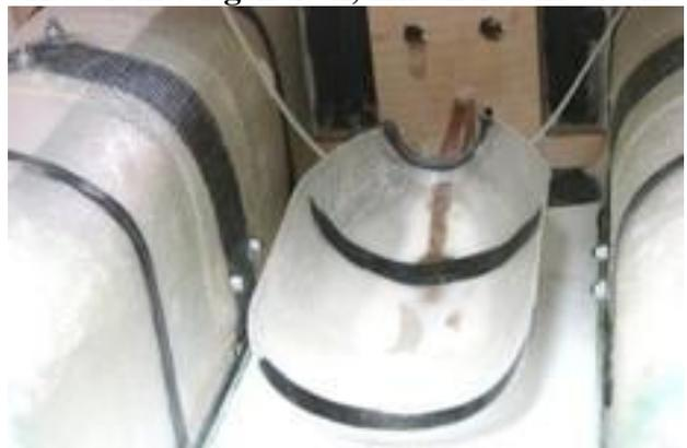
**Zwangskühlungen für den Motor aus 4mm Balsa geschnitten und eingeklebt**
