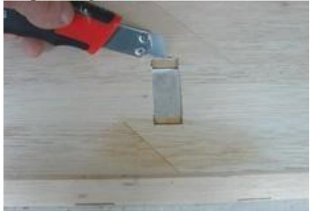
Doppelte GFK-Ruderhörner anzeichnen, mit Dremel rausschneiden und Kabel einziehen
