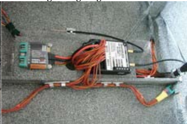
Einbau Empfänger + Weiche und die ganze Verkabelung kurz gezeigt !
