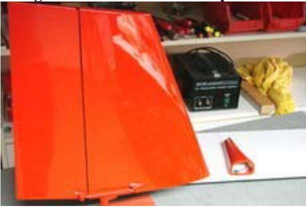
Fertige Seitenleitwerk und Rumpfbürzel in rot, eingebauter Zündungsschalter im Rumpf
