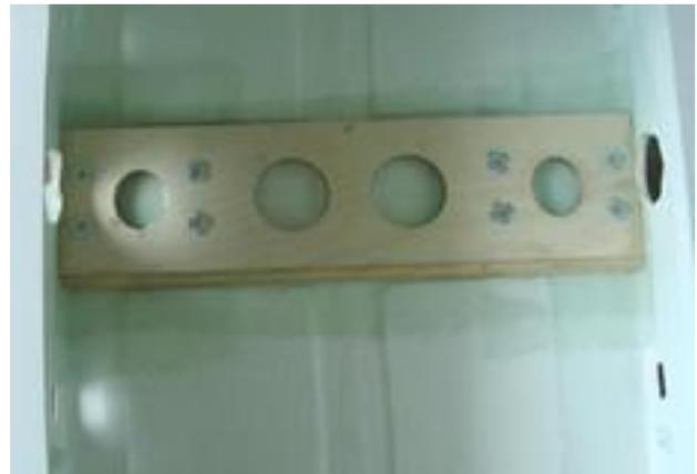
**Nach der Trockenphase kommen die beiden Verstärkungen für die Flächenwurzel an die Reihe, etwas an die Rumpfkontur angeschliffen und Probegesessen !**
