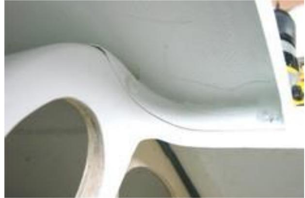
**Der Rahmenrand wird 15mm breit geschnitten und verschliffen, rechts das fertige Teil !**
