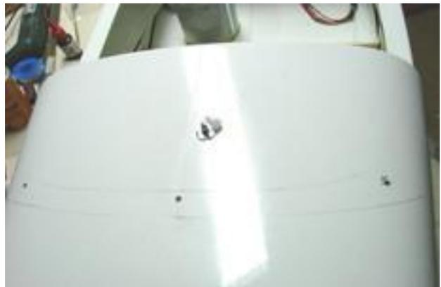
**Das eine Loch sitzt bei mir in der Mitte des Rumpfes, die anderen beiden jeweils 14cm davon nach außen versetzt, Einschlagmuttern in den Kabinenrahmen eingeklebt und auf den Rumpf zum Aushärten geschraubt.**
