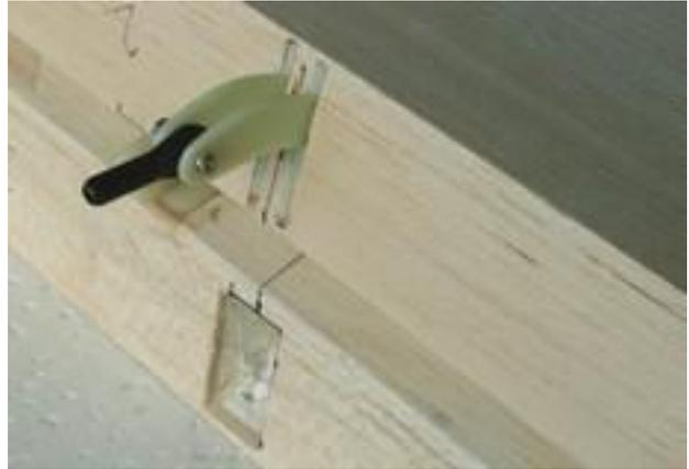
**Die Servoschächte sind für die Kästen mit 58x58mm vorgesehen, ich habe mir stabilere Halterungen aus Holz/GFK gefräst, können bei Bedarf bei uns mitbestellt werden !**
