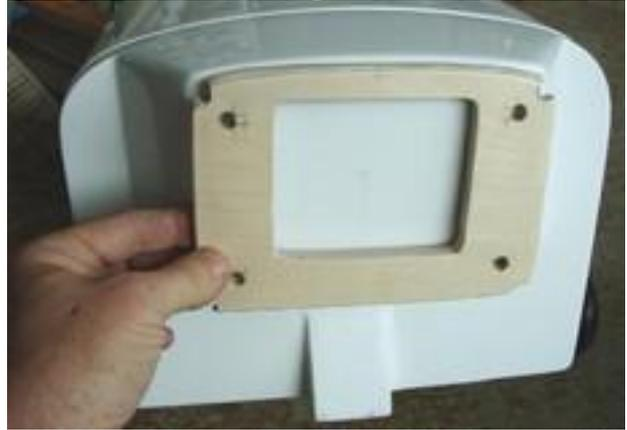
**Dieser wird der Rumpfrundung angepasst und geschliffen, mit CFK-Verstärkungen versehen**
