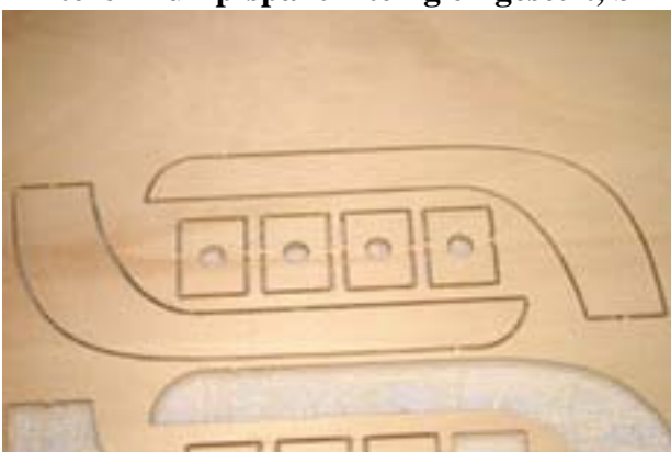
Hinterer Rumpfspant 2-teilig eingesetzt, bringt Steifigkeit im Seitenleitwerksbereich!
