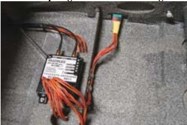
Einbau Empfänger + Weiche und die ganze Verkabelung kurz gezeigt !
