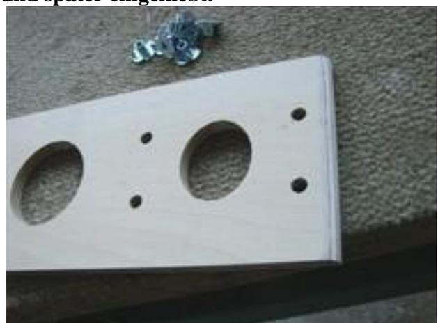
**Die neuen GFK / CFK-Rümpfe müssen nicht mehr vom Styro befreit werden, dort reicht ein anschleifen der zu klebenden Teile. Das Fahrwerksbrett kann unter Verwendung einer zusätzlichen CFK-Matte und bei aufgesteckten Tragflächenhälften und montiertem Fahrwerk verklebt werden.**
