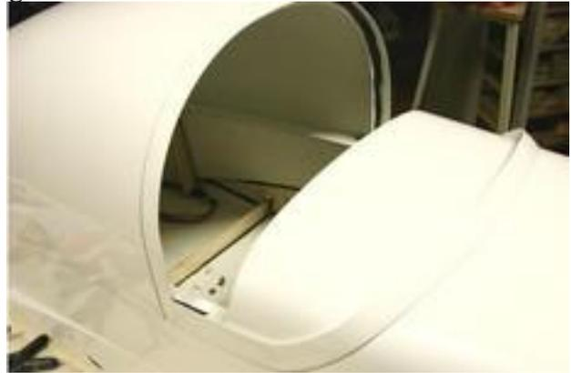
**Als Innere Haltezunge habe ich zwei GFK-Teile geschliffen und an die Innenseite der großen Schiebehaube geklebt, damit ist seitlich kein Verzug mehr möglich !**
