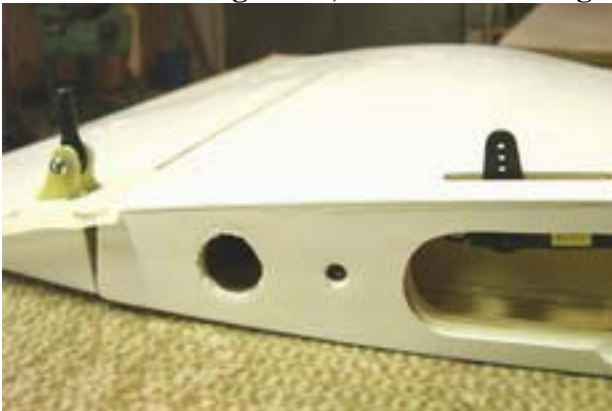
Ruderhörner eingeklebt, Servo in die fertige Servohalterung geschraubt
