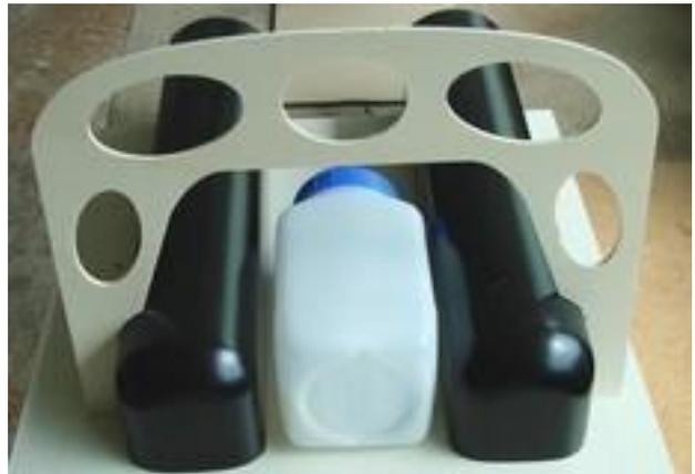
Auch bei diesem Spant kommt eine Endleiste 30x10mm zum Einsatz, bevor der ganze Spant mit Harz und Gewebestücken im Rumpf verschwindet.
