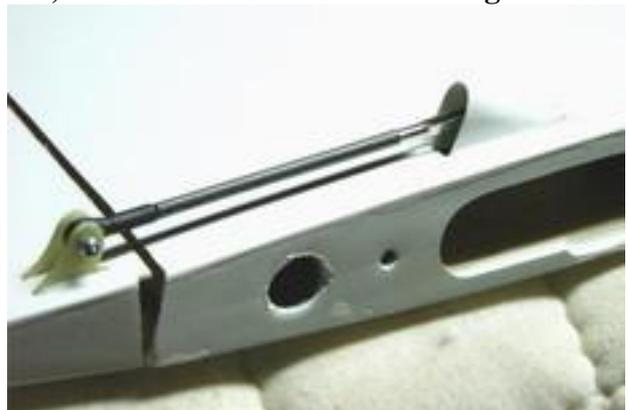
**Hinterer Rumpfspant 2-teilig eingesetzt, bringt Steifigkeit im Seitenleitwerksbereich!**
