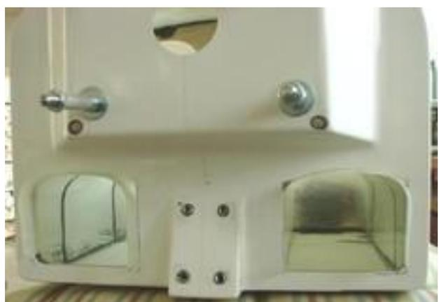
Die Dämpfertunnel werden im vorderen Bereich dem Rumpf angepasst, Ecken abgeschnitten so dass die Tummel von hinten in den Rumpf geschoben werden können.
