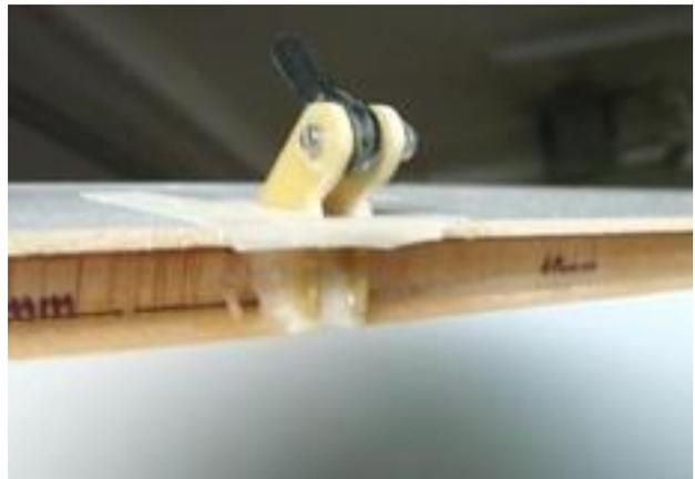
**Servos einsetzen und mit langem schmalen Schraubendreher einsetzen.**
