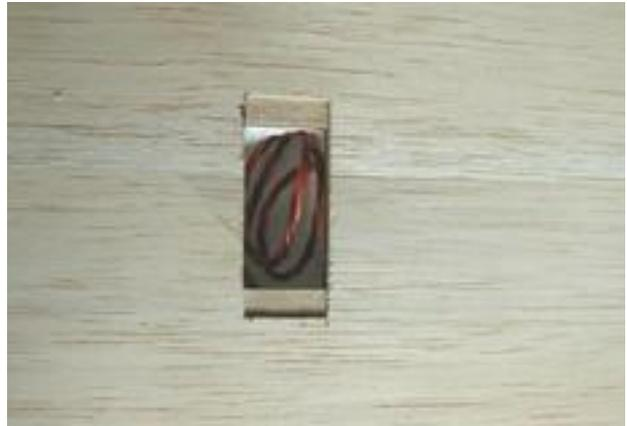
Landeklappenscharniere werden auf der Klappe verteilt, die Positionen der Verstärkungen unter der Balsabeplankung sind mit feinen Bleistiftstrichen angezeichnet ( 4 Stück je Klappe )
