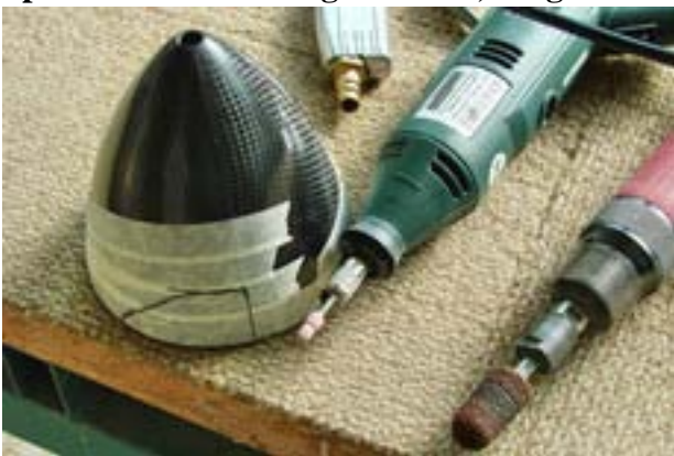
Spinnerausschnitt angezeichnet, ausgeschliffen und mit Kantenschutz versehen !
