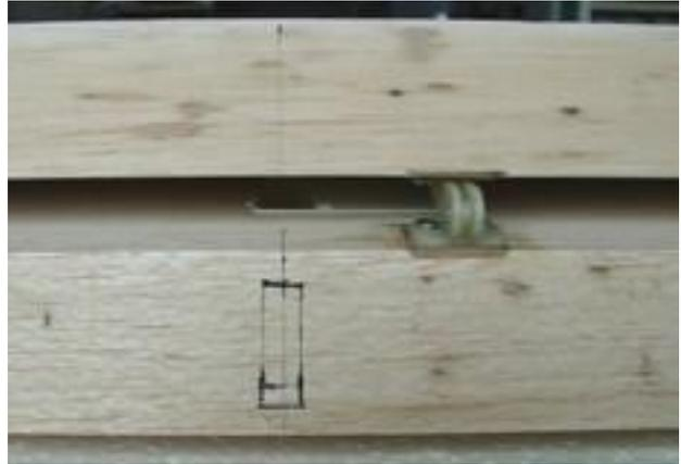
**Position der doppelten Anlenkung festlegen, mit einem Handschneidegerät lässt sich ein Draht biegen, schnell und einfach aus dem Styropor schmelzen, siehe Fotos !**
