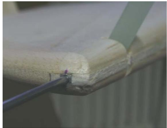
Das mittlere Lager aus 2mm Sperrholz wird nicht mit verklebt, die Lage der Messinghülse mit eingeschobener GFK-Zunge wird auf dem rechten Foto sehr gut sichtbar !
