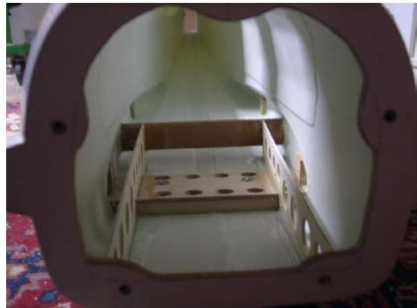
Links: Die Verstärkung der Verdrehsicherungen der Tragfläche aus Sperrholz ist auf diesem Foto gut zu erkennen. (30/30mm ) Rechts: Alle Einbauten im vorderen Rumpfbereich fertig verharzt und mit GFK-Matte zum Rumpf hin abgestützt. Von vorne gesehen: Motor-Ringspant, 2 Schiffchen zwischen Ringspant und Flächensteckung, Fahrwerksbrett und Steckungshülse !
