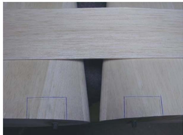
Links: Modell wurde um 180° Grad gedreht und unter den Kabinenausschnitten unterlegt um den Fahrwerksüberstand an den Flächen anzuzeichnen. Rechts: Die angerissenen Linien werden 5mm größer angezeichnet, herausgefräht und mit 3mm Balsa verkastet !
