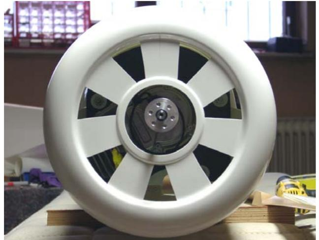
Links: Der 95er King an seinem endgültigen Arbeitsplatz. Rechts: Die Ausschnitte der Motorhaube garantieren den minimalsten Luftwiderstand und die beste Kühlung, eine Motorartrappe kann auch verwendet werden. ( Original hatte 7 Zylinder-Stern Motor ! )
