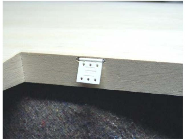
Links: Mit einem Kegelfräßer werden die Scharniertaschen freigearbeitet, diese sitzen ca. 5mm unter der Beplankung. Rechts: So kommen die Großmodell-Scharniere von Kavan an Ihren Platz !
