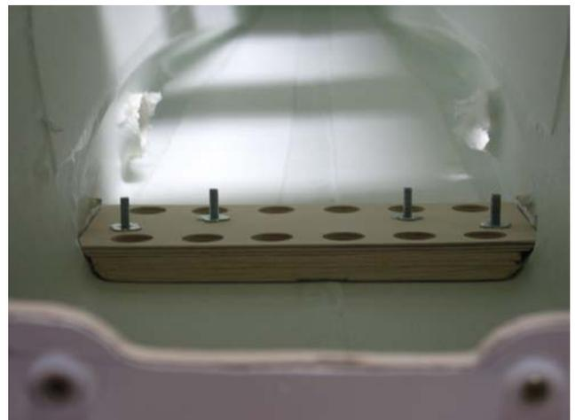
Links: Der eingesetzte Ringspann mit den 5 Verschraubungspunkten und den Ausbuchtungen für die Gummilagerung . Die weißen Kunststoffteile markieren die Bohrungen für die Motorhalterung.
