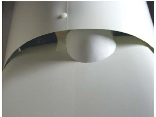
Links: Der von innen gesehene Kühlluft-Einlass für den Krümmer inkl. der Verstärkung aus 1-2 Lagen 120-150g/m<sup>2</sup> Gewebe. Rechts: So sieht die Verkleidung von unten gesehen mit weißer Bespannfolie versehen dann im fertigen Zustand aus !
