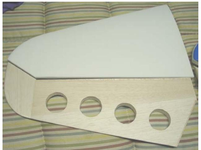
Links: Die Anlenkungen der Quer + Höhenruder muss mit M3er Gewinde und Kugelköpfen gemacht werden, doppelte GFK-Anlenkungen sind auch kein Fehler ! Rechts: Die Quer+Höhenruder können bei Motoren bis 100ccm aus Gewichtsgründen mit Erleichterungslöcher versehen werden, Vorsicht, Material für Ruderhörner stehen lassen !
