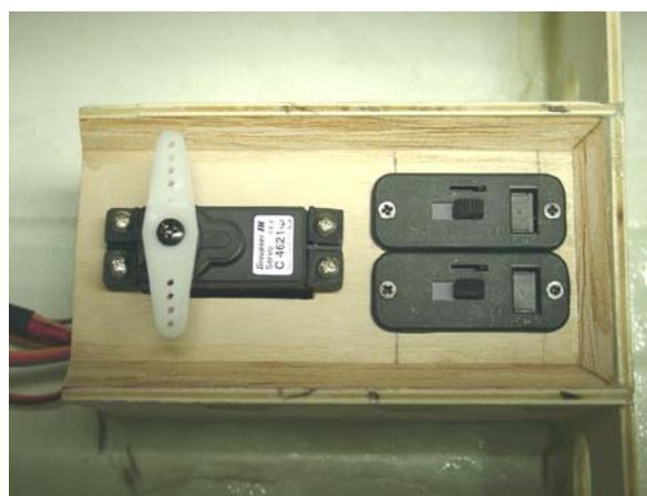
Auf diesen Bildern ist der Sitz für: Schalter, Seitenruder+Heckfahrwerk-Servo, Empfänger mit allen Kabeln kommt unter den Aufbau. Ich habe diesen Aufbau noch mit Balsa-Dreikantleisten verstärkt was wenig Gewicht aber viel mehr Stabilität bringt !
