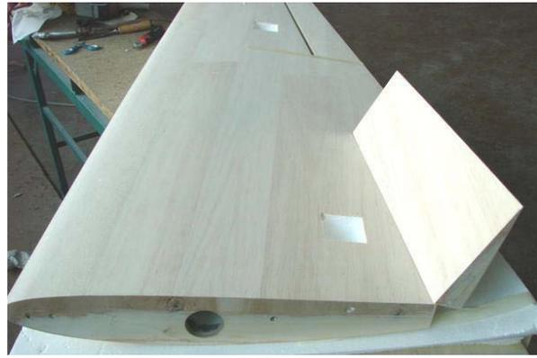
Jetzt neu mit fertig eingebauten Landeklappen, diese sind wie die Querruder zu bearbeiten, große Scharniere in die fertigen Scharnirtaschen einsetzen und die Klappen anlenken. Innere oder äußere Klappenanlenkung nach eigenem Ermessen und Geschmack einkleben ! ( Innere Anlenkung ist bei unserem Schleppmodell RANS S-19 sehr gut beschrieben )
