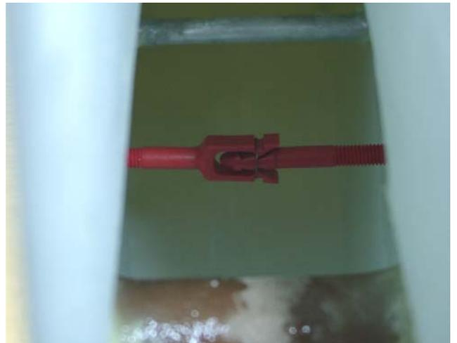
Links: Die eingearztete Alu-Hülse mit dem 6mm Gewinde für die Höhenleitwerkssteckung. Rechts: Die fertige Steckung von Graupner mit einem zusätzlichen Ring, es können bis zu zwei zusätzliche Ringe aufgesetzt werden !
