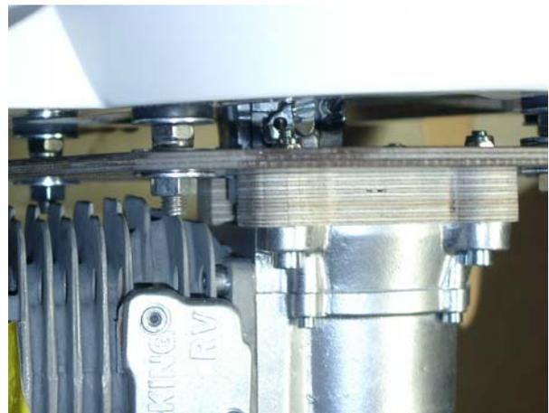
Links: Eine Blindmutter in Ihrem Auslieferungszustand, bevor diese im hinteren Teil zusammengedrückt wurde. Rechts: Die Vogelperspektive zeigt die komplette Motorhalterung mit dem kleinen Holzspant der für den 95er King nötig ist, da sonst die Kühlrippen auf den Motorspant gedrückt werden würden.
