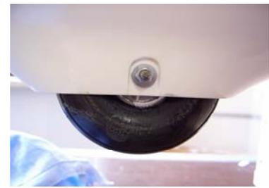
Analog wird mit dem Spornrad verfahren. Hier wird ein Graupner Leichtrad mit 85mm eingebaut.
