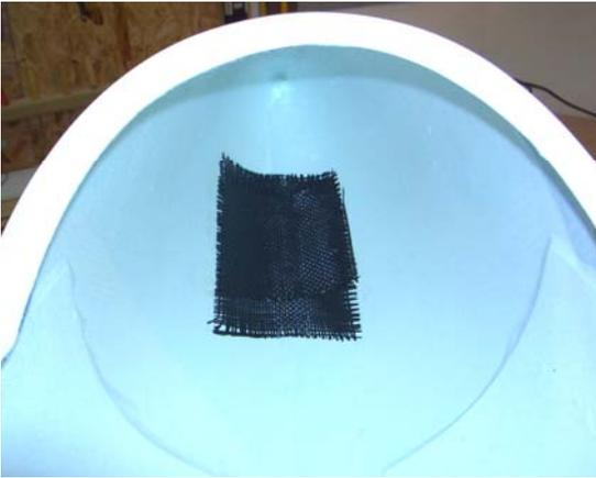
Abbildung 7: Schleppkupplung Kohleverstärkung
