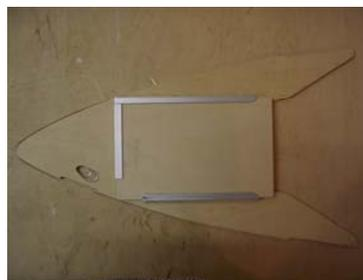
*Abbildung 13: Akkuspannt mit Akkubrett eingeschoben*
