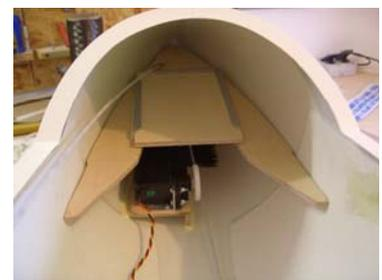
*Abbildung 14: Akkuspannt in Rumpfspitze*
