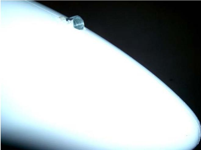
Als nächstes kommt die Schleppkupplung an die Reihe, diese sollte unterhalb der Rumpfspitze montiert werden, (50mm nach hinten), so verlaufen die Schlepps völlig stressfrei und ohne groß in die Knüppel greifen zu müssen.
