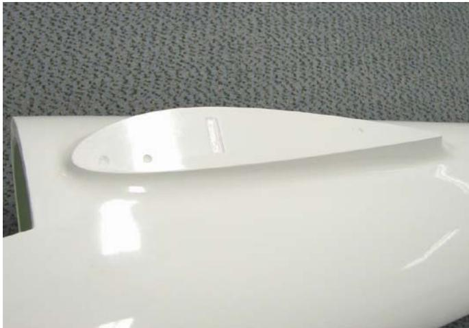
Dazu die Hülse ca. 5mm zu lange absägen, an einer Rumpfseite mit 1 Tropfen Sekundenkleber fixieren, danach die passende Flächenhälfte aufschieben und mit Klebeband fixieren.
