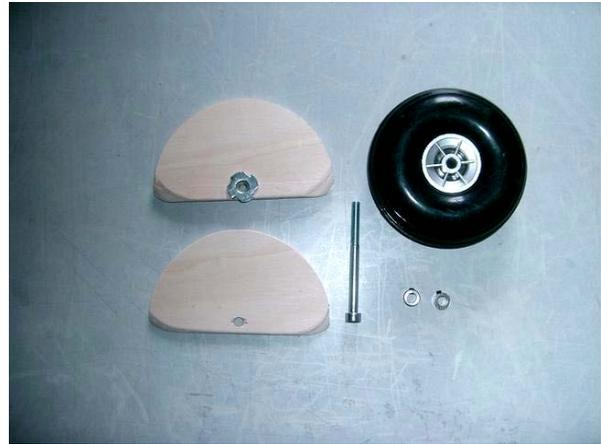
Die Halbkreisförmigen Verstärkungen ( 4-6mm Sperrholz ) für das Rad werden der Rumpfkontur angepasst und mit montiertem Rad im Rumpf stellenweise fixiert. Nach der Demontage des Rades wird die ganze Einheit mit Langzeitharz und GFK-Matte fest mit dem Rumpf verklebt.
