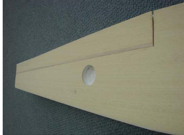
Die Befestigung der Flächen am Rumpf kann mit Schrauben, Gummis oder dem schon vorbereiteten Schnappverschluss erledigt werden.
